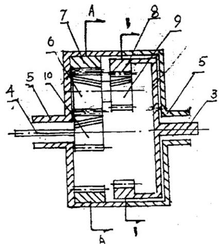
1、一种单级超低速行星齿轮电动减速机、由电机(1), 减速机构(2)组成,其特征在於:电机(1)主轴(4)上连接太阳齿轮(10),在太阳齿轮(10)的外周齿上有三只呈等距的行星齿轮(6)与太阳齿轮(10)啮合、三只行星齿轮(6)外侧有固定内齿轮(7)与之啮合,三只行星齿轮(6)上各连接有多于行星齿轮(6)一齿的过桥齿轮(9),少于固定内齿轮(7)一齿的输出内齿轮(8)与三只过桥齿轮(9)啮合。
